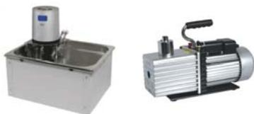
В полевой лаборатории с помощью термостата (термостат - водяная баня TW – 2.02) проба шлама нагревается, создается вакуум (вакуумный насос GL 2Z-12) и через дегазатор проба газа перегоняется в барботер.
