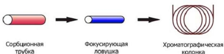
Рис 1. Принцип работы двухстадийного термодесорбера
