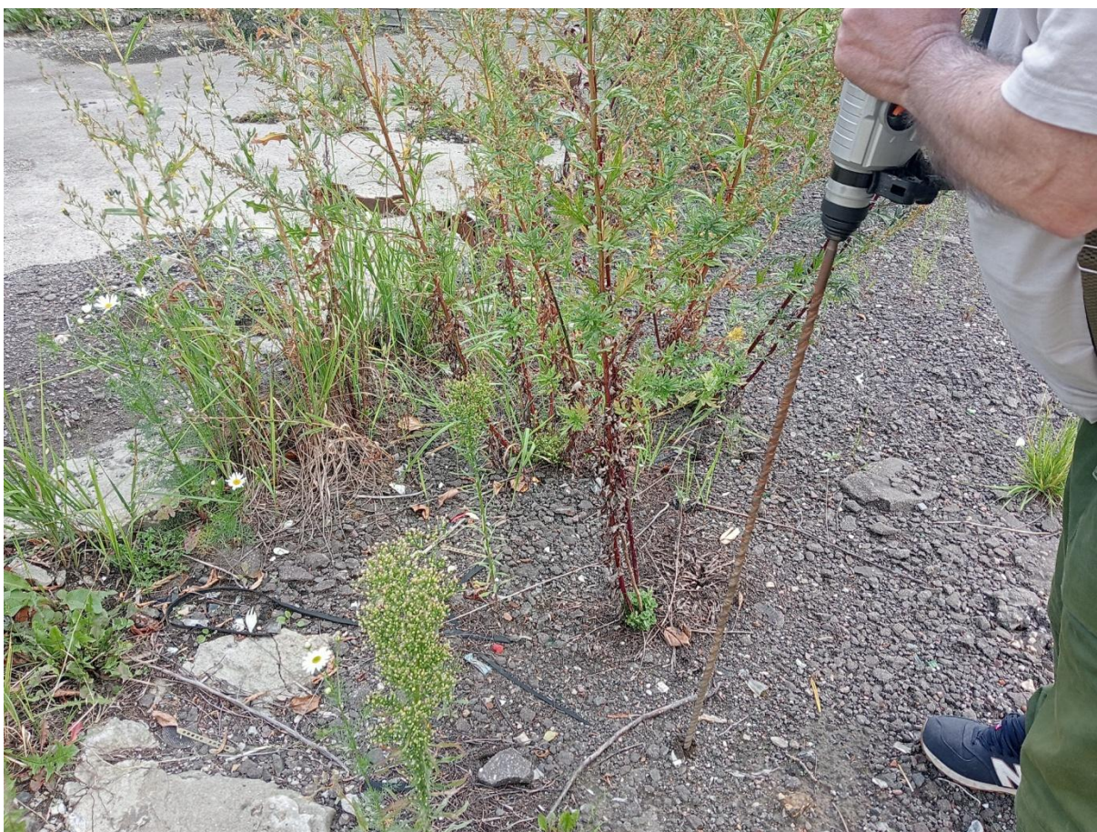
Рисунок 3 – Проходка шпурового отверстия
