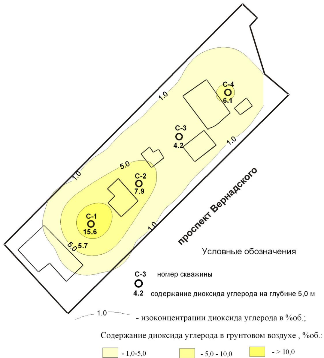
Рисунок 5 Распределение диоксида углерода на глубине 5,0 м
