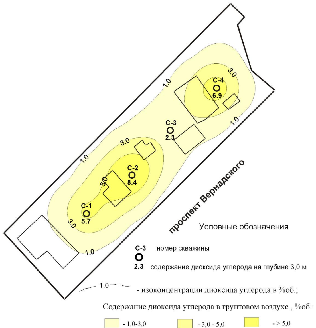
Рисунок 3 Распределение диоксида углерода на глубине 3,0 м
