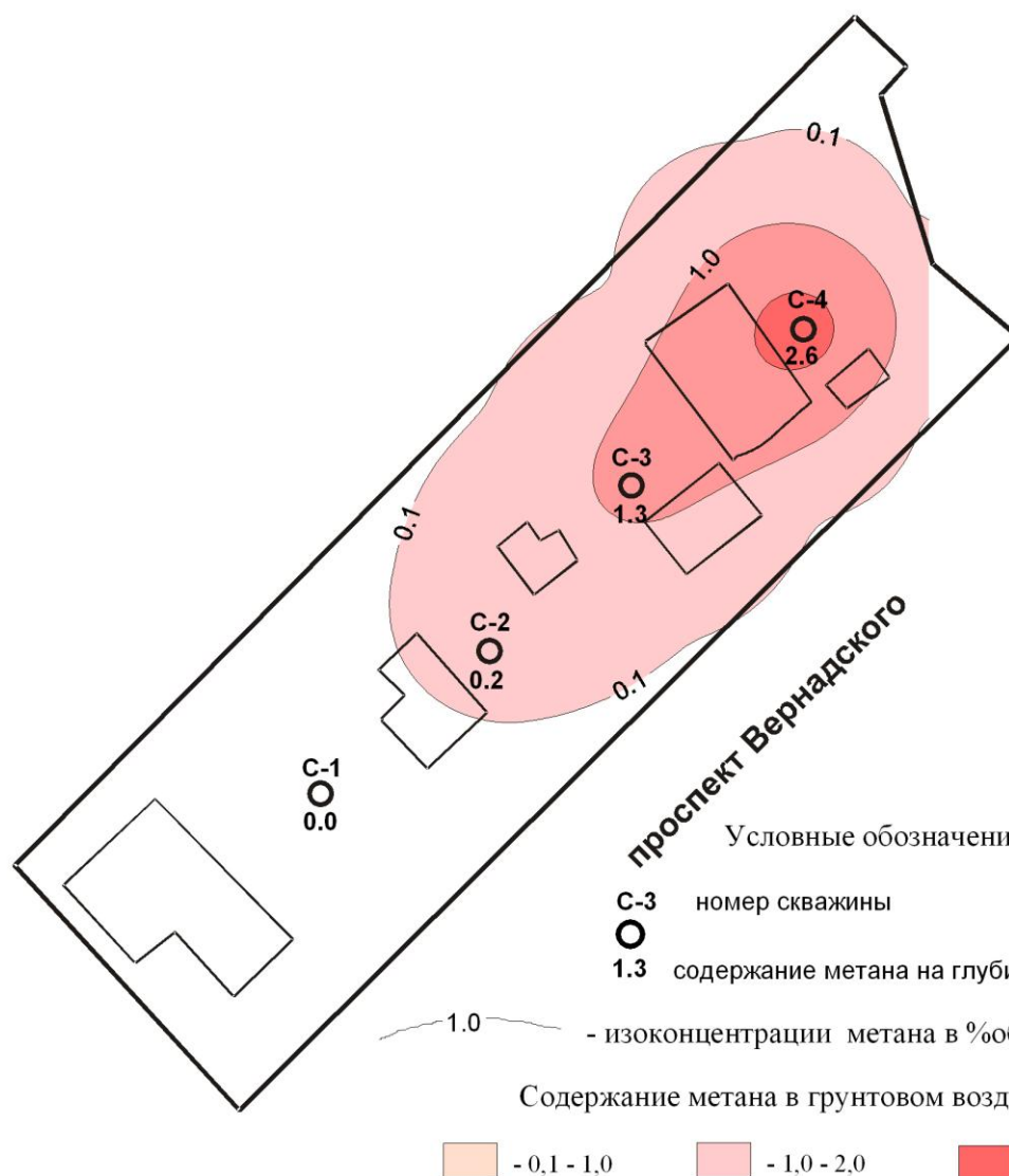
Рисунок 4 Распределение метана на глубине 5,0 м
