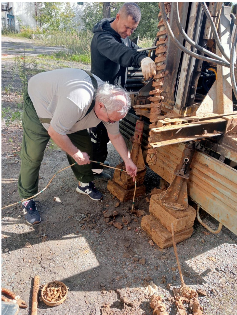
Рисунок 1. Отбор пробы грунтового воздуха из скважины
